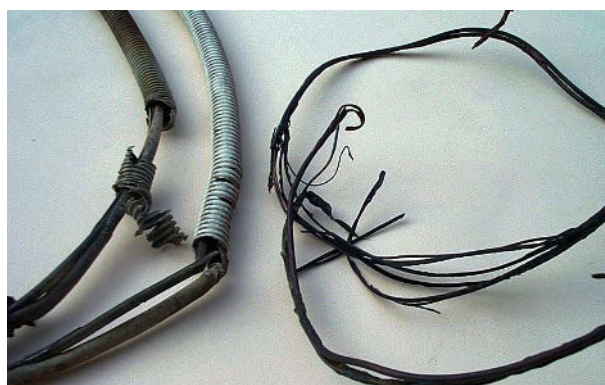
Fig 3 : gaine du câble antenne TV fondue (à gauche) et câble électrique carbonisé (à droite)
