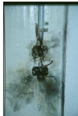
Fig 4 : prise de courant détruite
