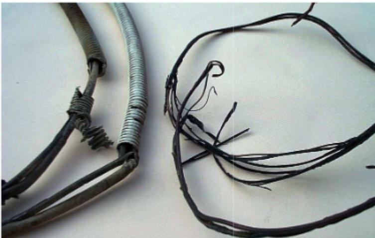
*Fig 3 : gaine du câble antenne TV fondue (à gauche)
