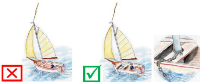
Pourquoi ? Le mât constitue un point haut susceptible d'être frappé par la foudre. Si celui-ci est isolé de l'eau ou n'est pas protégé, le courant de foudre, une fois en bas du mat, peut se propager dans tout le bateau et entraîner des destructions fatales (perçage de coque, destruction des antennes situées sur le mât par exemple).
