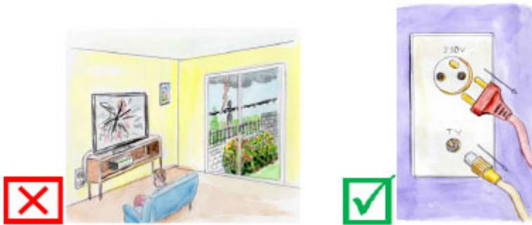
Pourquoi ? L'antenne constitue un point haut susceptible de capter les coups de foudre. Le câble d'antenne va conduire le courant de foudre vers la TV, voire dans toute l'installation électrique entraînant la destruction de plusieurs appareils électrodomestiques.
